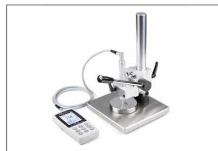
Banc d'essai pour mouvements d'essai reproductibles. Cela permet d'exclure toute erreur comme lors d'une utilisation manuelle de la sonde. On obtient ainsi des mesures encore plus stables et plus précises, voir *Accessoires*
